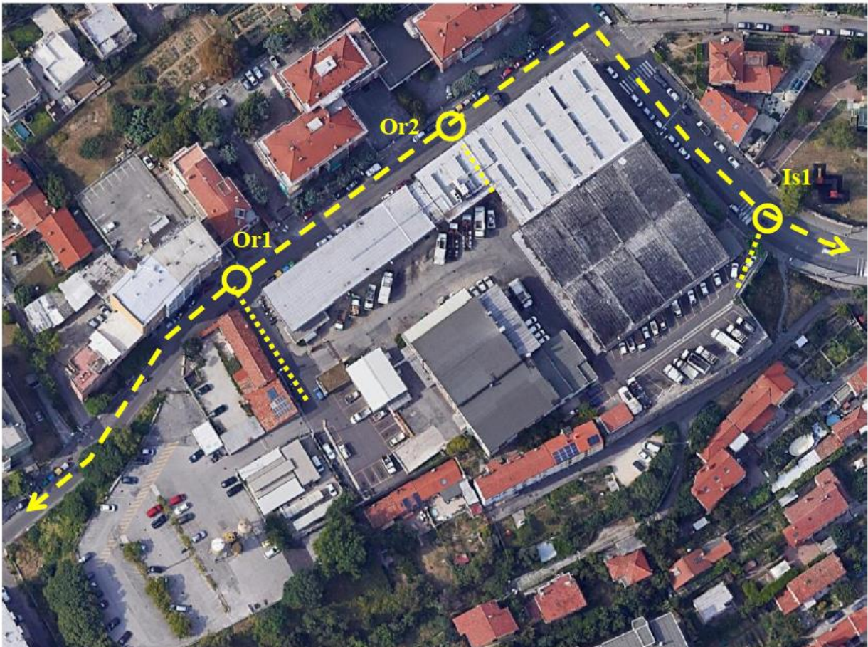
Figura 3.6: Indicazione dei punti di allaccio in fognatura di tutta l'area
